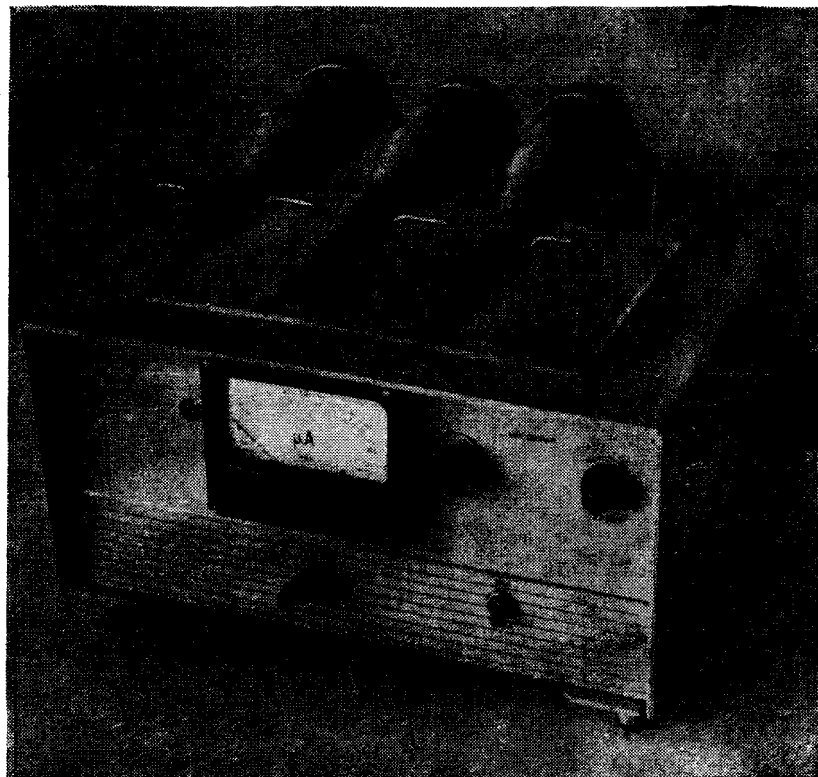
Рис. 48. Ультразвуковой генератор с комплектом волноводов.
